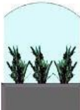
C. Esempi di pannellature di protezione trasparenti (non colorate) in plexiglass o vetro temperato/stratificato di sicurezza che dovranno essere preferibilmente "frameless" (privi di intelaiatura) con telaio di disegno semplice in metallo di colore opaco (h. max m 1,60)
